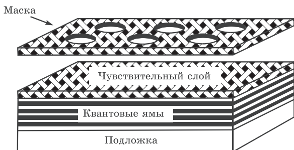
Рис. 4.20. Четырехслойная конструкция из квантовых ям на подложке, покрытой чувствительным слоем. Сверху показана маска для облучения при литографии
