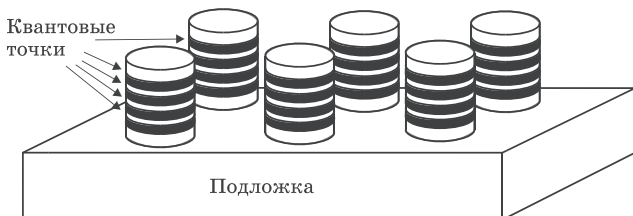
Рис. 4.21. Массив квантовых точек, полученный с помощью литографии из квантовых ям (см. рис. 4.20)
